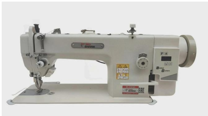
Одноигольная прямострочная машина челночного стежка с верхним («шагающая» лапка-перетоп) и нижним продвижением, увеличенным челноком, встроенным серводвигателем
