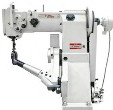
Одноигольная машина двухниточного челночного стежка с унисонным продвижением, увеличенным вылетом рукава, увеличенным челноком, встроенным серводвигателем с регулировкой скорости и позиционером
