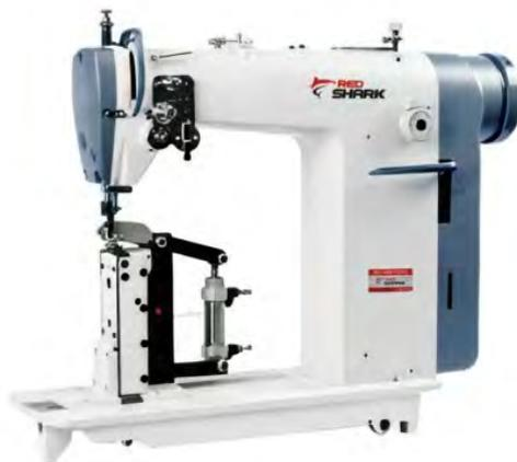
Одноигольная машина челночного стежка с колонковой платформой, устройством подачи и пневмоустройством обрезки тесьмы
