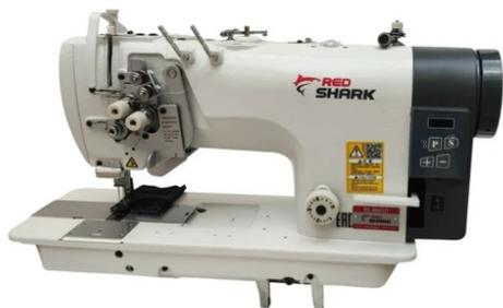
Двухигольная прямострочная машина челночного стежка с игольным и нижним продвижением материалов, с отключением игл и встроенным серводвигателем
