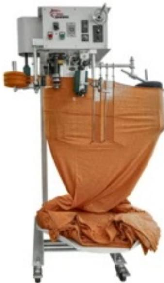
Автоматическая машина вертикального типа с тремя ножами
