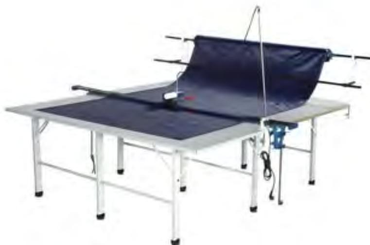
Ручная отрезная линейка с дисковым ножом и прижимной линейкой.
