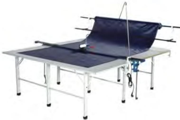
Ручная отрезная линейка с дисковым ножом без прижимной линейки.
