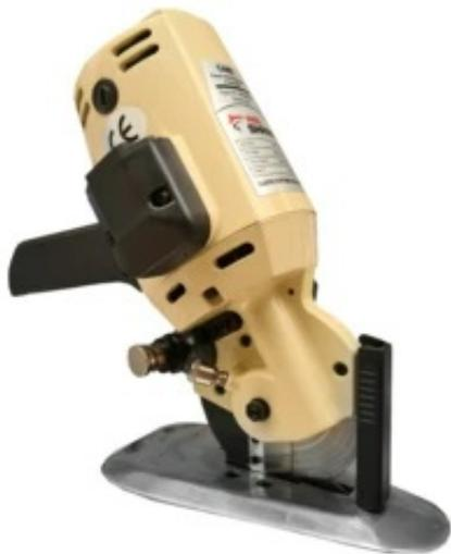
Примение: для раскроя полотен и настилов (высотой до 27 мм) из различных материалов
